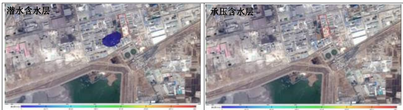
图 6.2.4-46 盐酸储罐泄漏氯化物 500d 预测结果
